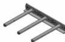
Figur 2a, Monteringsmuligheder for kontrolslange
