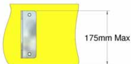
Abb. 3 - Positionierung der oberen Haltewinkel
