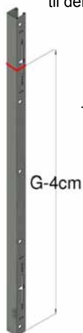
Figur 8, Sådan skæres styreskinnernes længder.
