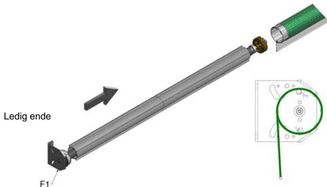
Figur 6b, Sæt fjedersamlingen ind i det øverste rør
