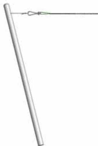
Abbildung 4, Ausrichtung der Pfosten
