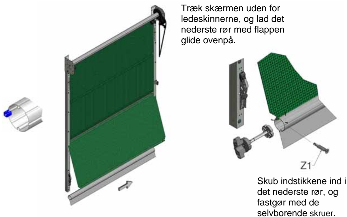
Figur 16a, Fastgørelse af det nederste rør
