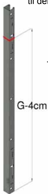
Figur 8, Sådan skæres styreskinnernes længde.
